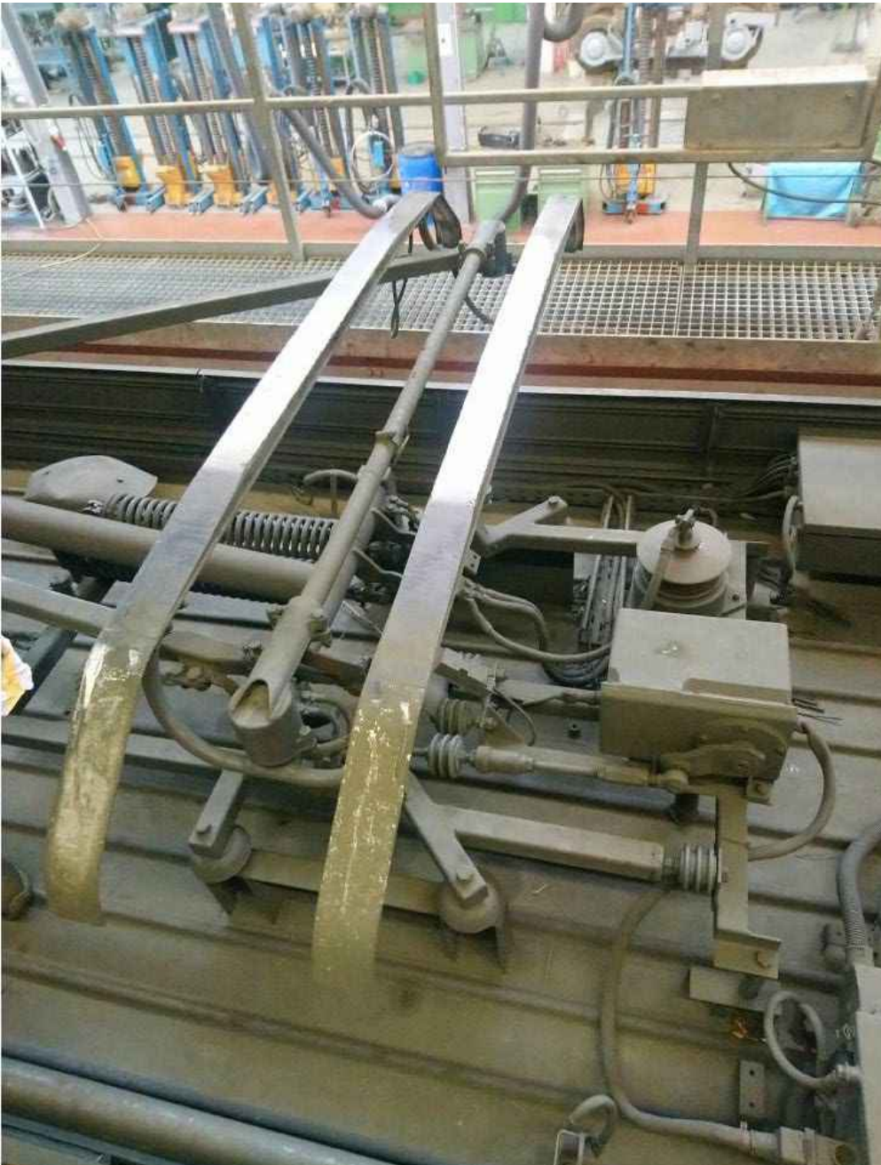
Abbildung 5.1: Aufnahme eines Stromabnehmers aus Graphit auf dem Betriebsgelände der VBBr (fotografiert durch Dr. Andreas Kerschbaumer)
