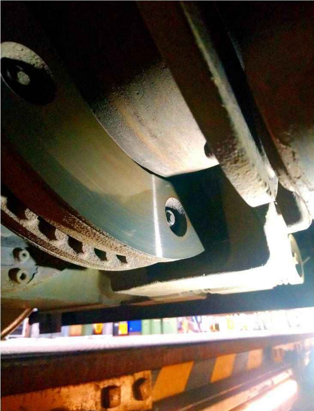
Abbildung 5.3: Aufnahme einer Bremsscheibe an einer angetriebenen Achse einer üblichen Straßenbahn auf dem Betriebsgelände der VBB (fotografiert durch Dr. Andreas Kerschbaumer)
