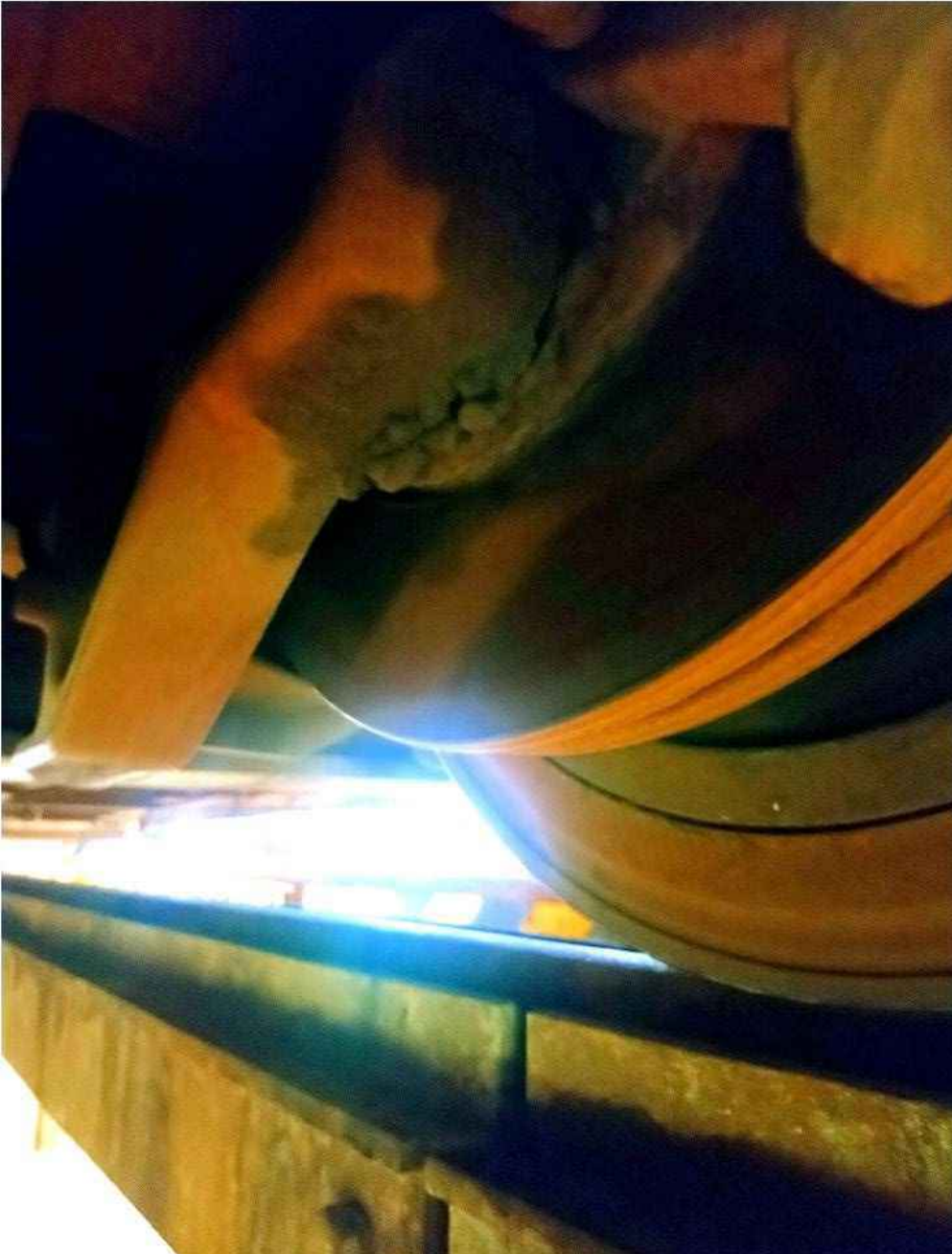
Abbildung 5.4: Aufnahme einer Bremsscheibe an einer passiven Achse einer üblichen Straßenbahn auf dem Betriebsgelände der VBB, deutlich sichtbare Staubablagerungen sind erkennbar (fotografiert durch Dr. Andreas Kerschbaumer)
